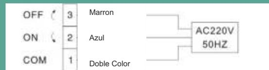
Debe ser utilizado un termostato de 3 cables
